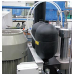
**3 Accumulatori per la gestione del circuito di ritorno dei cilindri idraulici**
