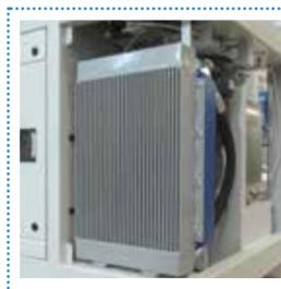
Scambiatore di calore aria/olio (std)
